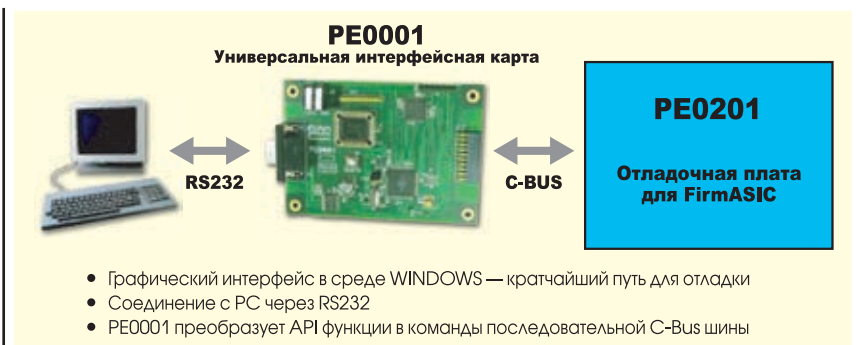
Рисунок 2 Конфигурация отладочных плат для загрузки и отладки микросхемы с помощью компьютера
